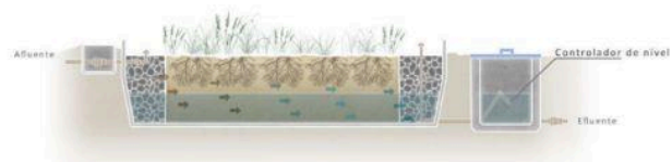
Figura 45 - Wetland Híbrido. Corte horizontal. Fonte: Guajava, 2023
