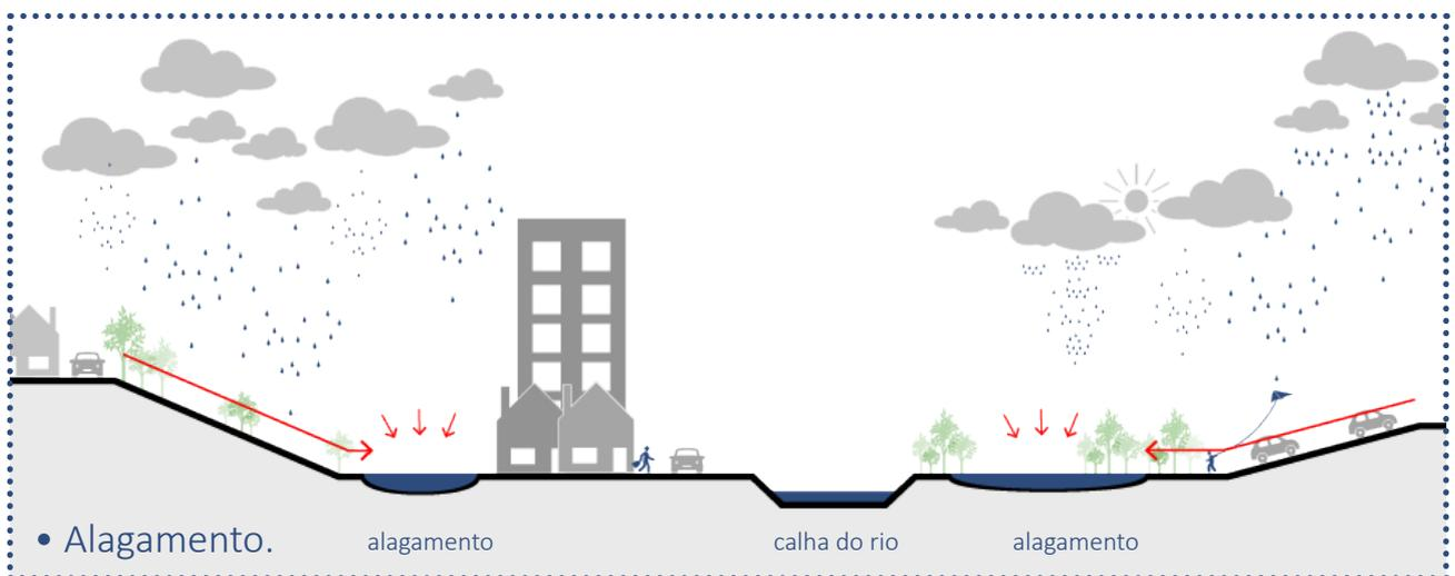
Figura 03 | Diferenças visuais entre Enxurrada, inundação e Alagamento | Fonte: Diagrama autoral.
