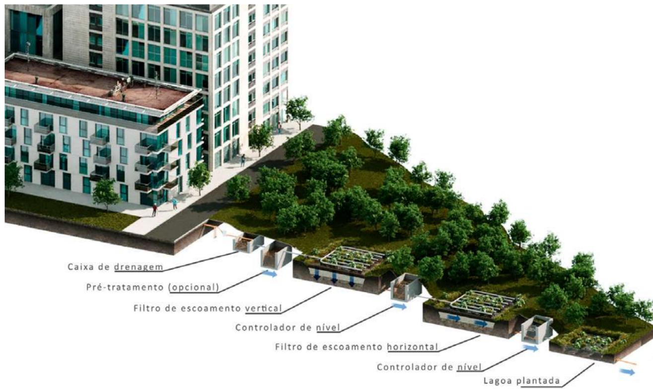
Figura 43 - Wetland Híbrido. Perspectiva isométrica. Fonte: Guajava, 2023
