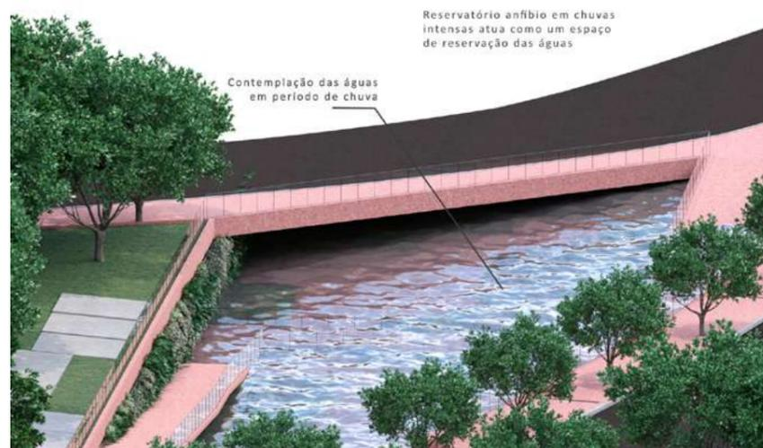
Figura 51 e 52 - Reservatório anfíbio vazio e cheio, vista externa. Perspectiva isométrica. Fonte: FCTH, 2021.
