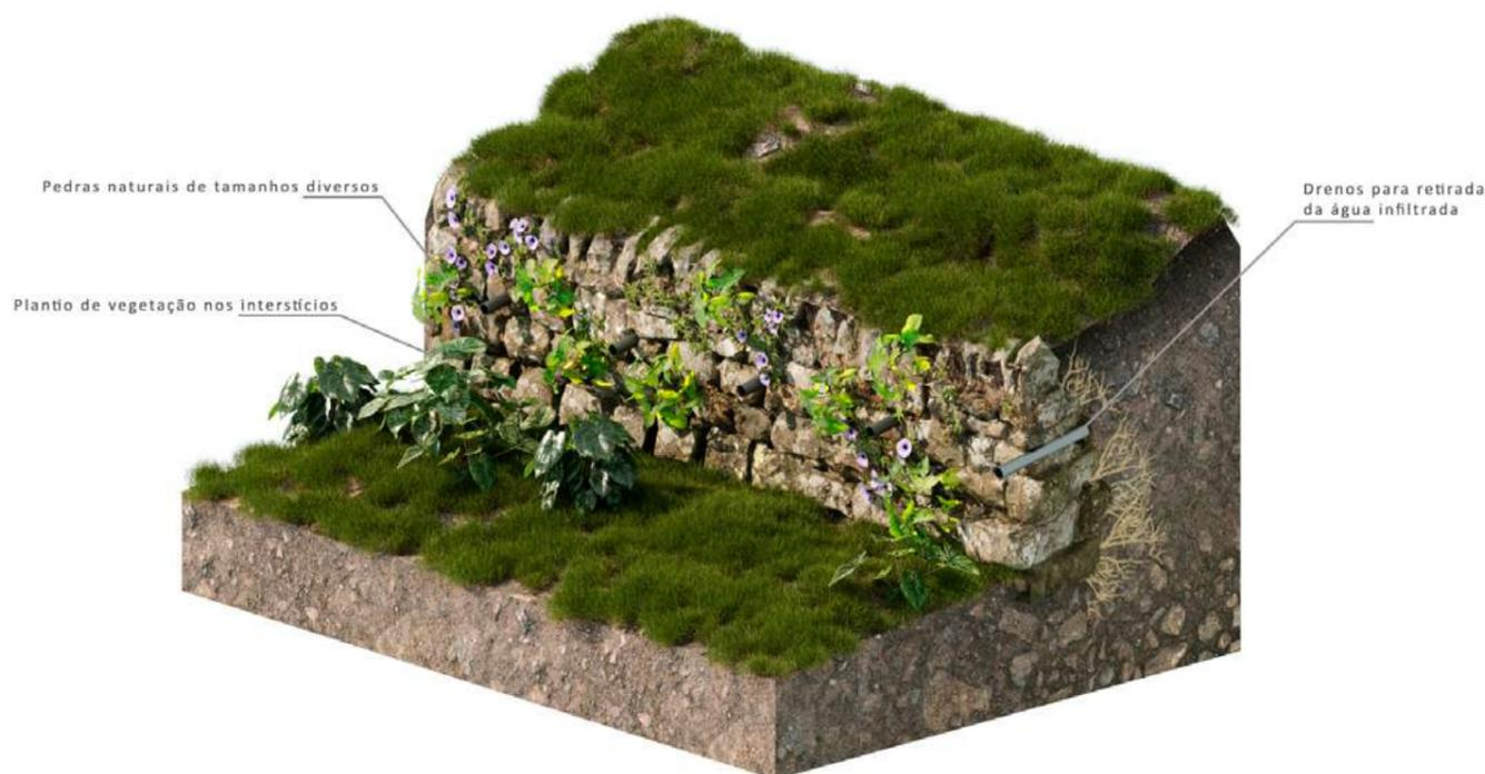
**Figura 64** - Muro de Pedra com Vegetação Viva. Perspectiva isométrica. Fonte: Guajava. Adaptado de Helgard Z., 2007)
