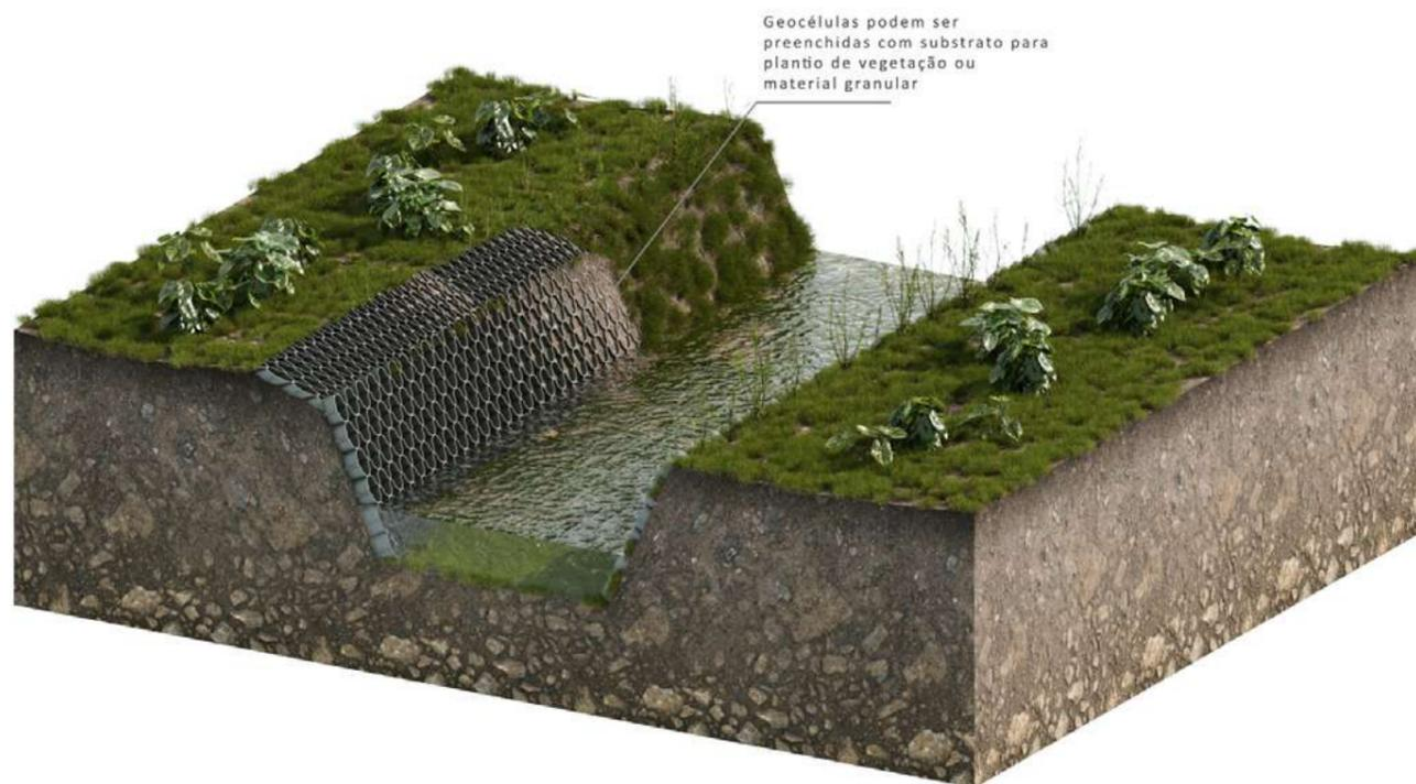
Geocélulas podem ser preenchidas com substrato para plantio de vegetação ou material granular
