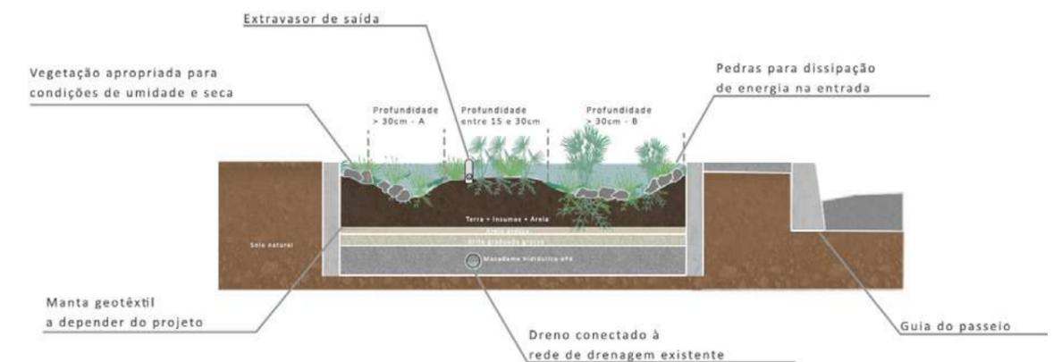
**Figura 20** - Canteiro pluvial com paredes laterais sem laje de fundo, com tubulação/duto de conexão com drenagem convencional existente (Fonte: Guajava, 2023)
