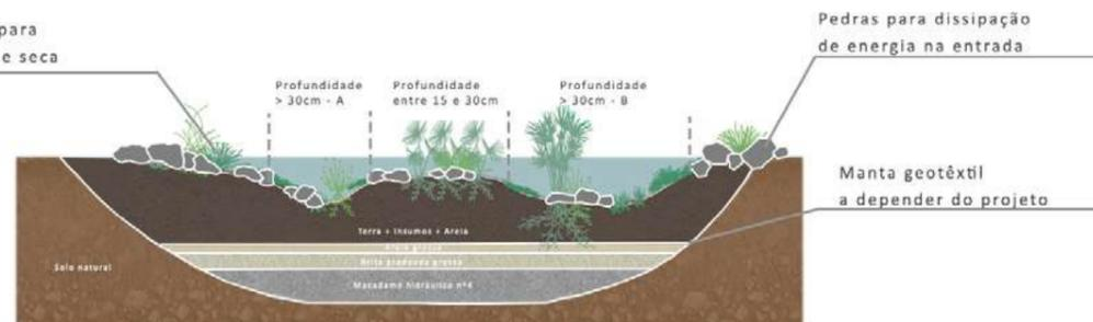
Figura 12 e 13 - Jardim de Chuva. Perspectiva isométrica com detalhe e corte. Fonte: Guajava, 2023
