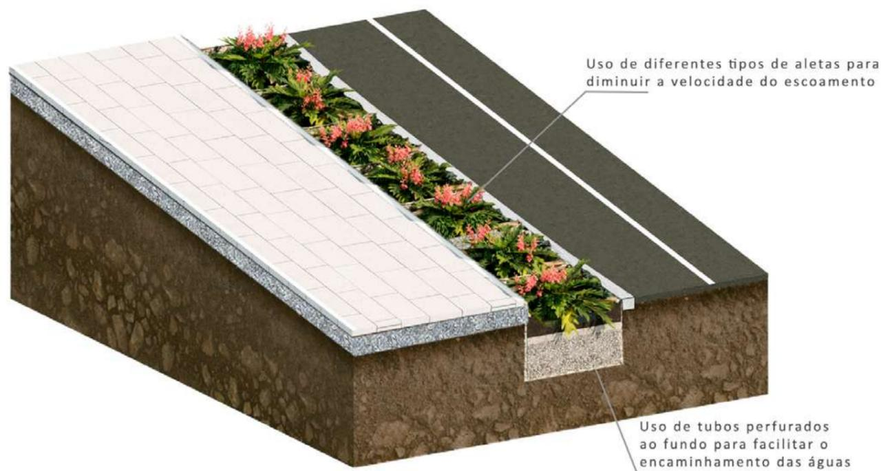
Figura 28 - Escada Hidráulica Vegetada. Perspectiva isométrica. Fonte: Guajava, 2023
