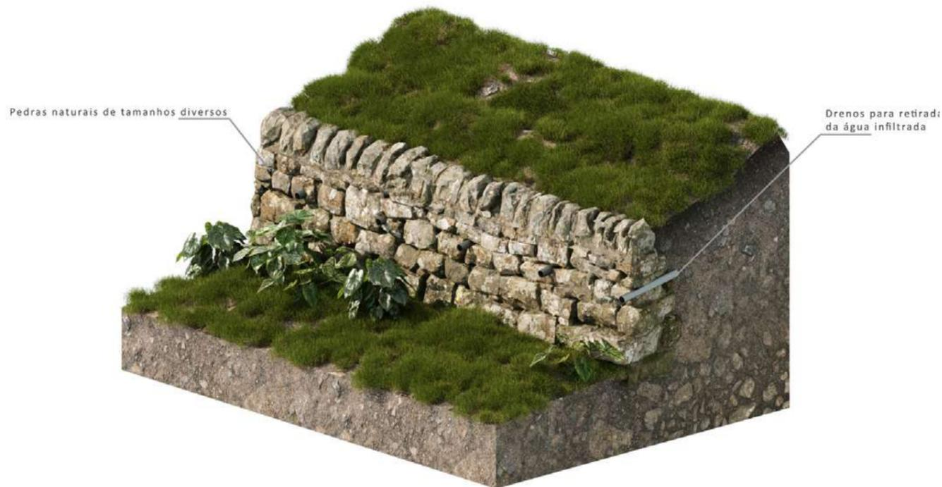
**Figura 62** - Muro de Contenção com Pedras. Perspectiva isométrica. Fonte: Guajava. Adaptado de Helgard Z., 2007)
